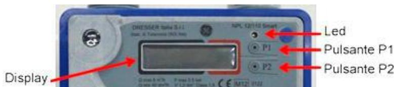
Come illustrato in figura, nella parte superiore del misuratore di gas sono presenti un display per visualizzare il totalizzatore interno e lo stato dell'elettrovalvola, i tasti P1 e P2 che permettono la visualizzazione dei dati e un Led che indica se il contatore è in trasmissione.
